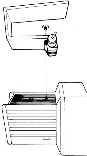
Placez le support orientable retourné sur le dessus du moniteur, l'ouverture face à vous. Faites coïncider l'attache de la console avec les encoches et le trou de vis placés sur le moniteur.
